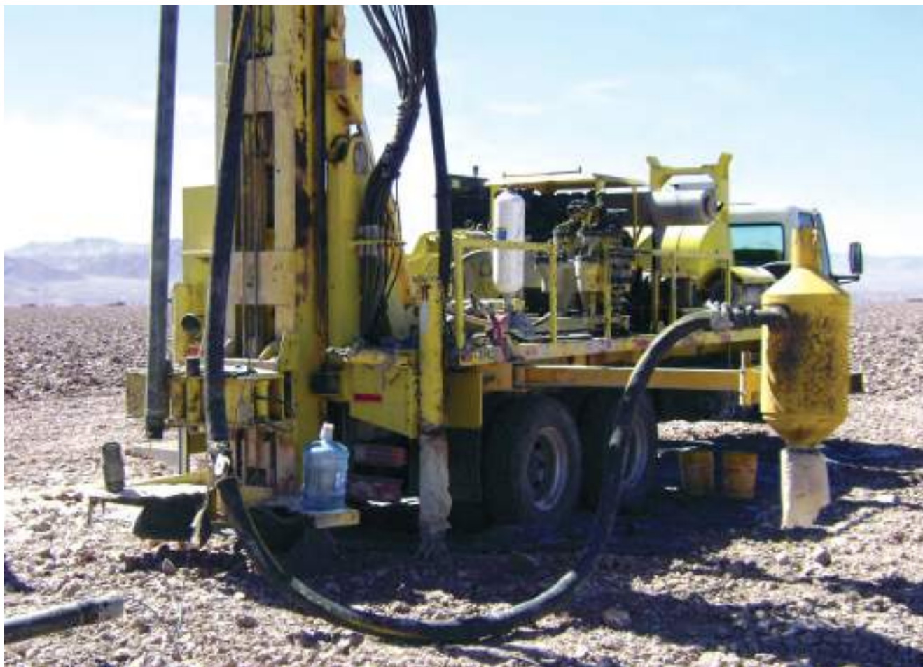
Perfuratriz Prominas modelo R-3H perfurando no método de circulação reversa com ar comprimido e hastes de parede dupla.
