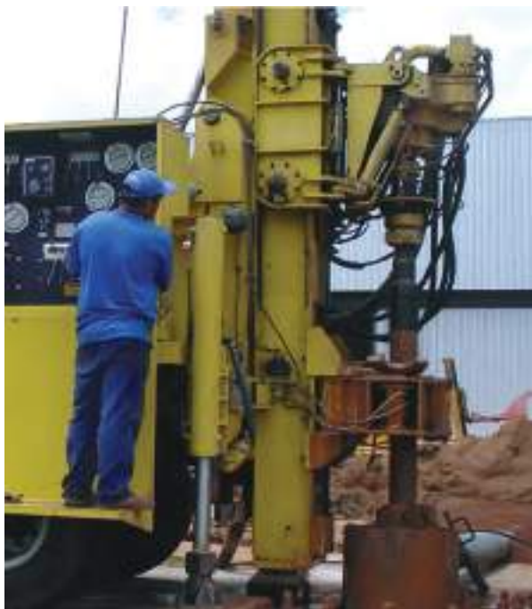
A coluna de perfuração é retida para acoplamento de uma nova barra Fig. 19A
